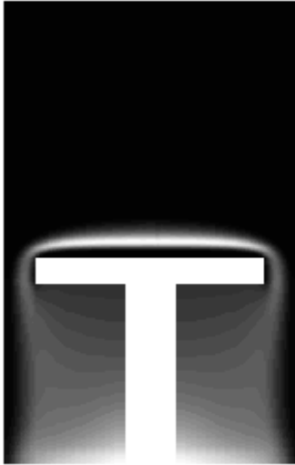
Рис. 1. Слой частиц при росте AlN в вертикальном реакторе, полученный в расчете.
