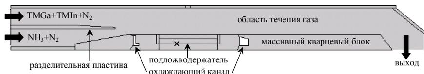
Рис. 1. Схема реактора AIX 200/4 RF-S.
