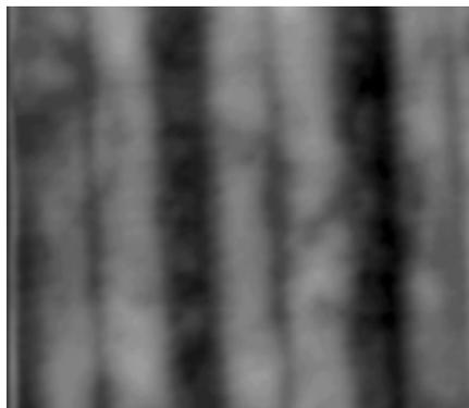
Рис.2. Растровое изображение поверхности образца GaN, выращенного методом ELOG, на РЭМ в режиме НТ на барьере Шоттки (размер кадра по горизонтали 40 мкм).
