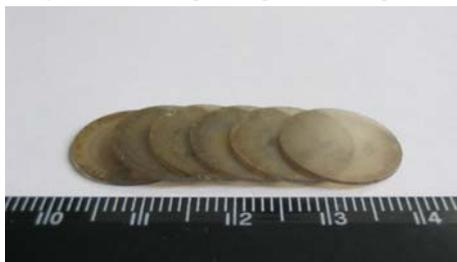
Рис.1. Пластины AlN после операций резки и шлифовки.
