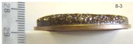
Рис. 1. Поликристалл AlN диаметром 2 дюйма.
