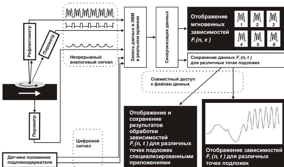
Рис. 1. Схема обработки информации в системе WaferScan
