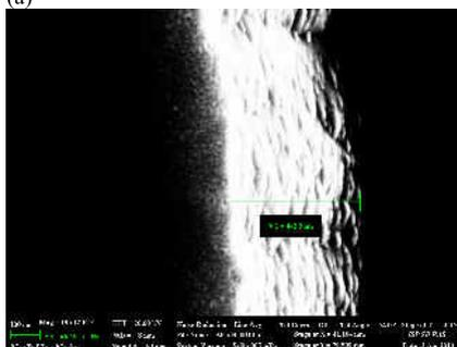
Рисунок 1. Изображения тестовых *pin*-диодов, полученные с помощью вторичной электронной микроскопии: а) Меза без металлизации; б) Меза с металлическим контактом; в) Вид на мезу сверху.
