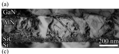
Рис. 1 ПЭМ изображение поперечного сечения гетероструктуры GaN/AlN/3C-SiC/Si(001) с разной разориентацией поверхности в направлении [110]: (a)  $4^\circ$ , (b), (c)  $- 7^\circ$ . В слое нитрида галлия стрелками отмечены дефекты упаковки (SF), возникающие в направлении [0001] нитрида галлия, ILs - промежуточные слои AlN и 3C-SiC.
