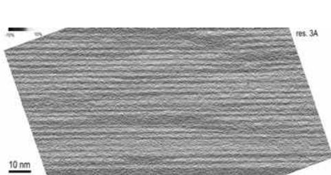
Рис.1. ПЭМ изображение поперечного сечения CP InGaN/GaN (время прерывания роста 80 сек)
